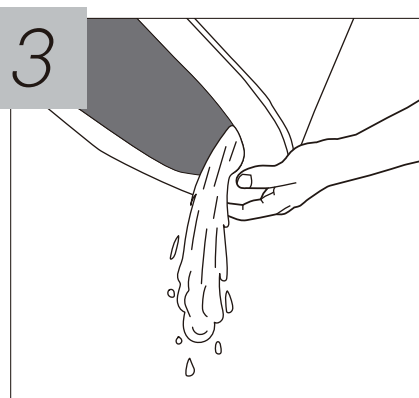
3 浴槽を傾けて残水を排出
