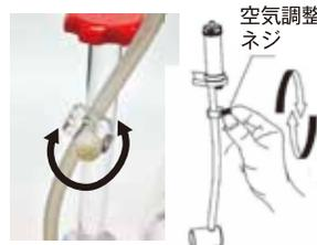
空気調整ネジを開閉させることで、空気を取り込み量が変化します。空気の量を多くするとスキマー内の水は上昇します。
