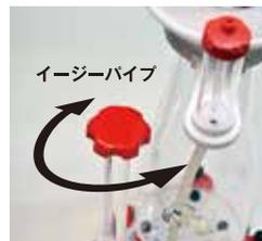
イージーパイプを左右に回転させることで、排水口の開口率が変化します。排水口が閉じると、スキマー内の水は上昇してカップから溢れてしまいます。適度な位置をイージーパイプを調整して見つけてください。設置した当初は汚れが少なくゴミの取れる量が安定しないので、約1週間程度は不安定な状態になります。様子を見ながら調整してください。
